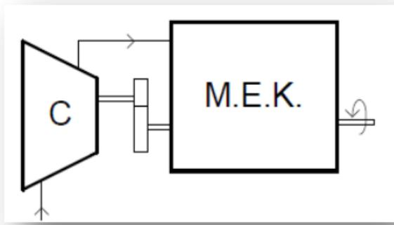
Χρησιμοποιείται σε κινητήρες Otto αυτοκινήτων με ή χωρίς ενδιάμεσο ψυγείο αέρα, με σταθερή (συνήθως) ή μεταβλητή σχέση μετάδοσης κίνησης.
