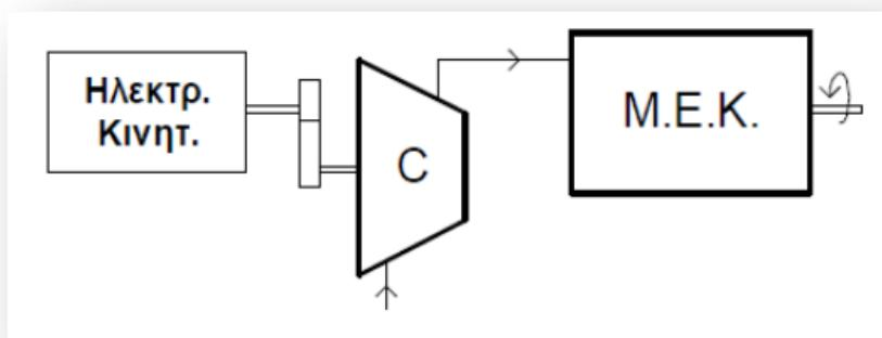
Χρησιμοποιείται κυρίως σε συστήματα υπερπλήρωσης αεροπορικών κινητήρων, ορισμένων κινητήρων Diesel, καθώς και για τη σάρωση 2-X κινητήρων φυσικής αναπνοής.
