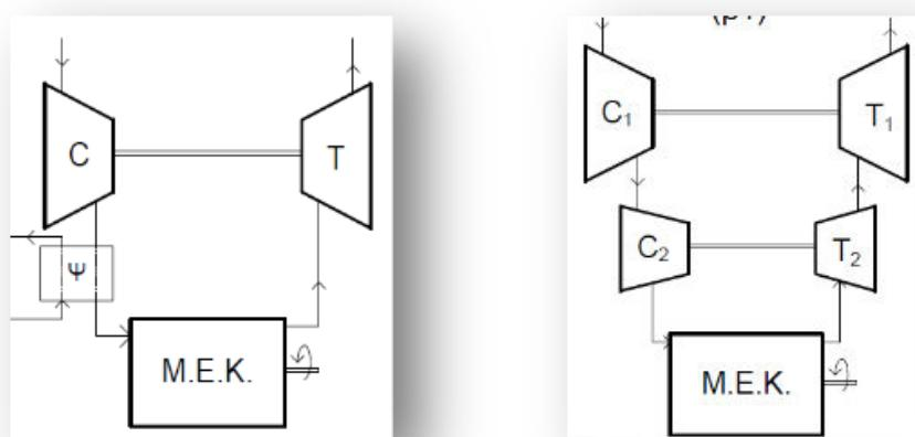
Αποτελεί τον πλέον διαδεδομένο τύπο υπερπλήρωσης με σχεδόν καθολική χρήση σε κινητήρες οχημάτων, βιομηχανικούς και ναυτικούς.
